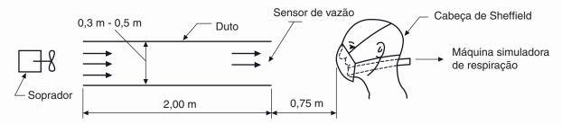
Figura 11 – Esquema da disposição de parte do equipamento para ensaio de CO<sub>2</sub>
