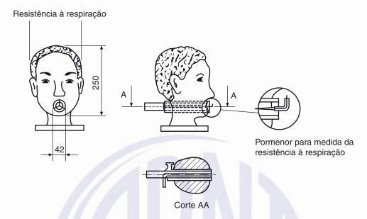
Figura 5 – Cabeça de manequim (cabeça de Sheffield) para a medida da resistência à exalação
